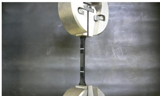
図2. CFRP射出成形品の引張試験
