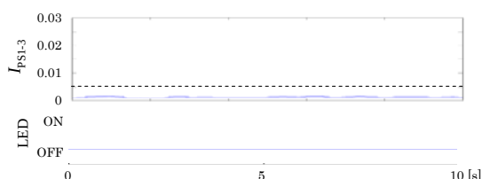
図11 横方向からのノイズの評価指標とLEDのON/OFF状態
