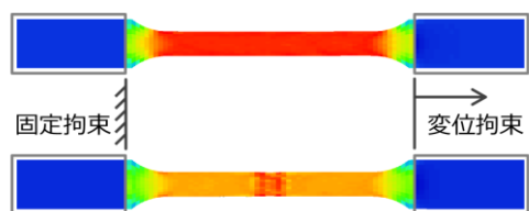
上: ウェルドライン無 下: ウェルドライン有 図5. 応力分布結果
