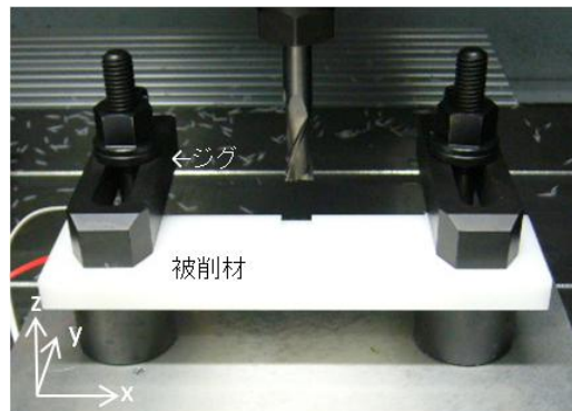
図2 被削材とジグからなる機械構造物
