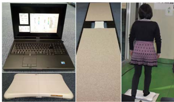
図2 床反力情報取得実験に用いた機材と実験風景
