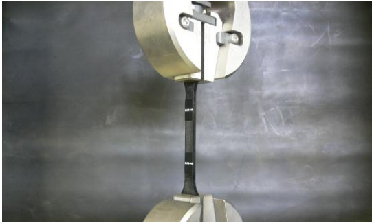
図2. CFRP射出成形品の引張試験
