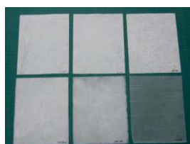
図1 各乾燥温度で得られた熱可塑性シート(A社) 上段左120℃～下段右170℃(10℃刻み)
