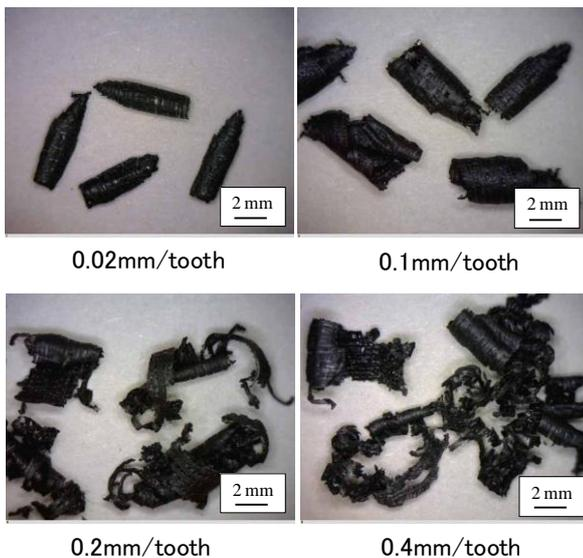
図6 送り変化による切りくずの様子
