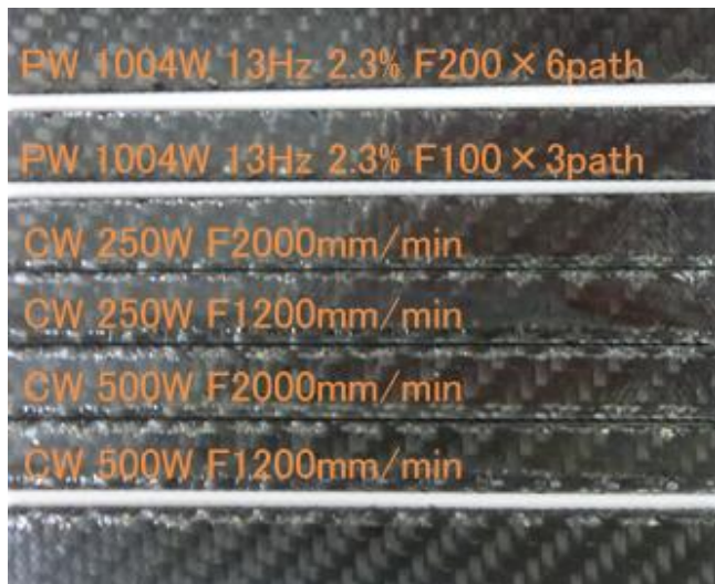
図3 回転ヘッドによる切断
