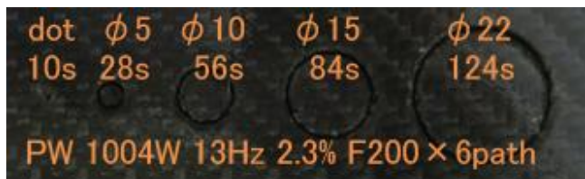
図6 従来ヘッドによるトレパニング加工
