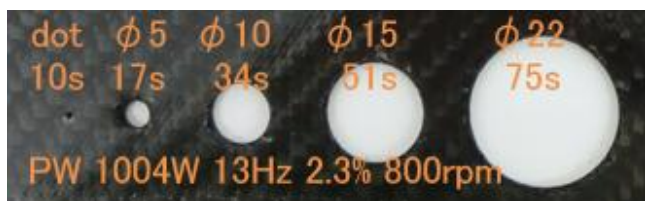
図5 回転ヘッドによるトレパニング加工
