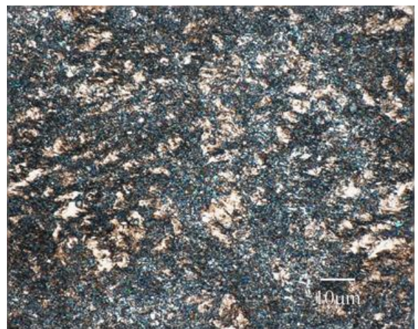
図 6 金型材料 SS400 を用いた プレス焼入れ SK85 組織
