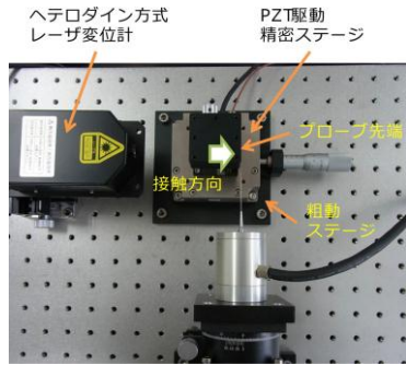
図9 接触位置検出の一方方向繰り返し精度の測定装置
