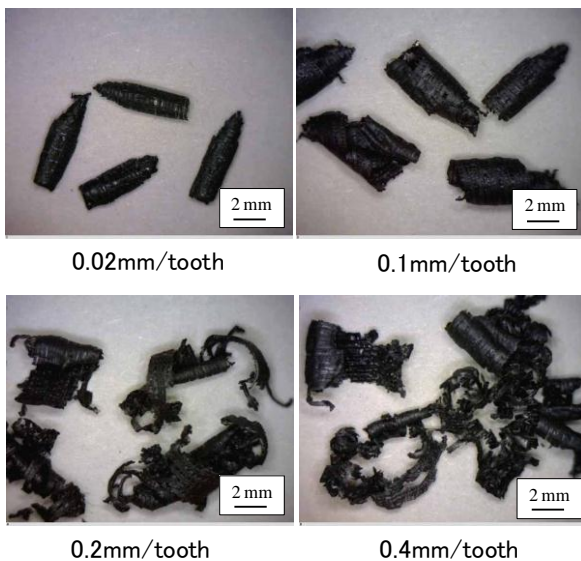
図6 送り変化による切りくずの様子 (回転数一定：6000min -1 )
