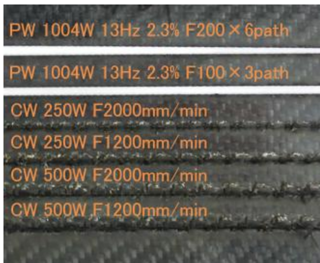
図4 従来ヘッドによる切断
