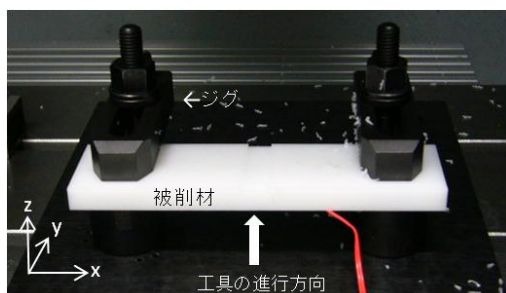
図1 被削材とジグからなる機械構造物
