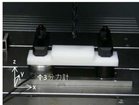
図3 ジグを用いた被削材の加工
