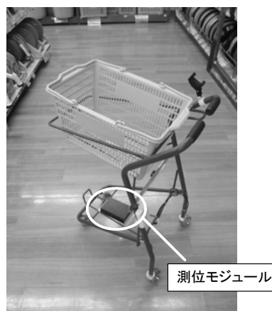
図1 測位モジュールつきショッピングカート
