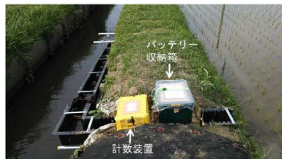
図2 現地での自動計数装置の設置（可児市今）
