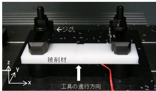
図1 被削材とジグからなる機械構造物
