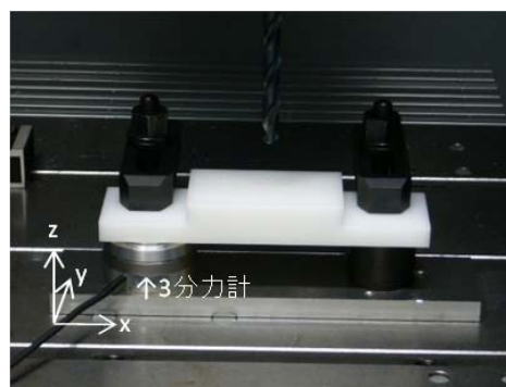
図3 ジグを用いた被削材の加工
