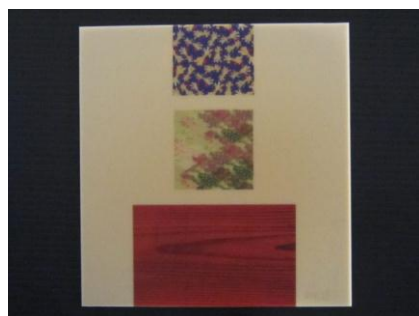
図4 インクジェットプリンターで印刷した紙を使用した複合材料
