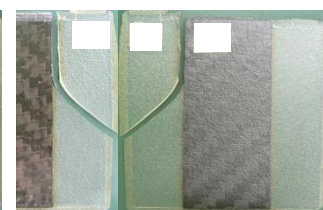
写真12 成形品離型後の熱可塑性樹脂板(PET)
