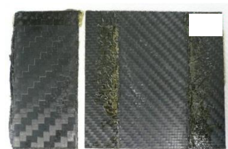
写真6 成形品離型後の熱可塑性CFRP(PA66)
