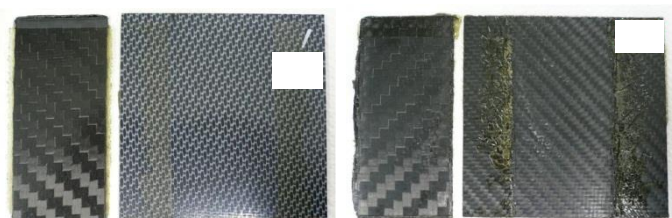
写真5 成形品離型後の熱可塑性CFRP(PEEK)
