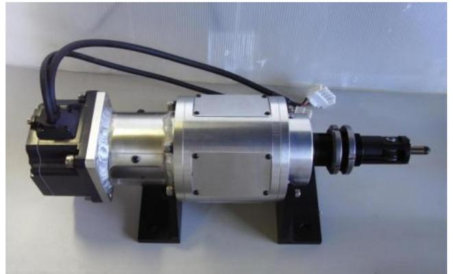
図4 ジャイロ式砥石穴あけ装置-2号機のジャイロ加工ヘッド部
