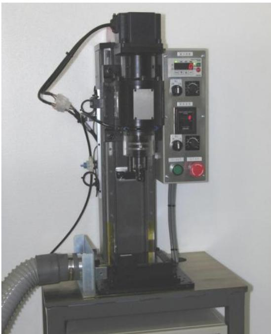
図3 ジャイロ式砥石穴あけ装置-1号機
