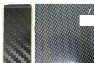
写真5 成形品離型後の熱可塑性CFRP(PEEK)
