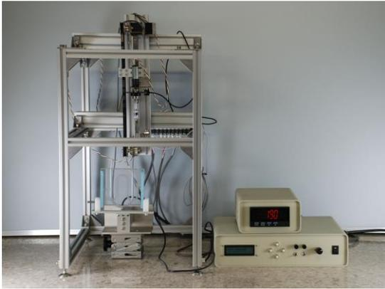
図7 摩擦評価装置
