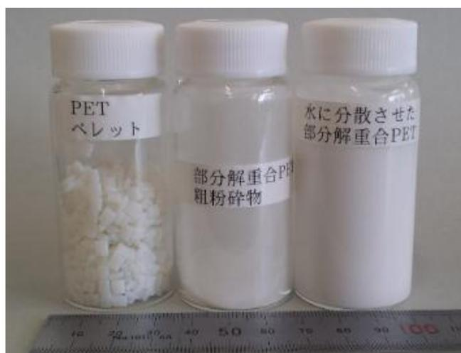
図2 部分解重合PETの外観
