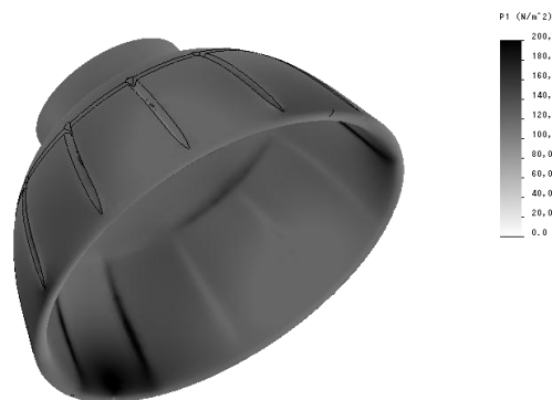
図4 割れ誘導線裏(15°, 45°, 75°)の最大主応力
