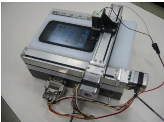
図1 XYプロッタシステム
