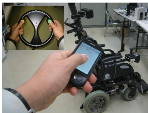
図7 加速度センサ式コントローラ
