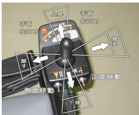
図6 標準レバーでのアーム操作方法
