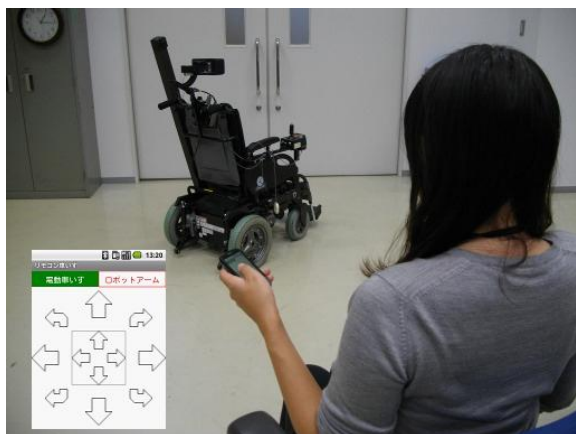
図1 スマートフォンによる電動車いすの遠隔操作
