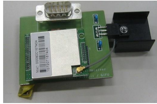
図3 WiFi通信モジュール実装基板
