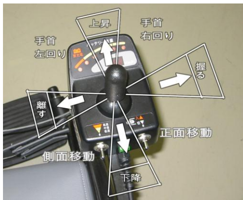
図6 標準レバーでのアーム操作方法
