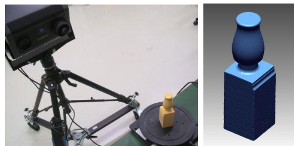
図1 非接触三次元計測システムと測定例
