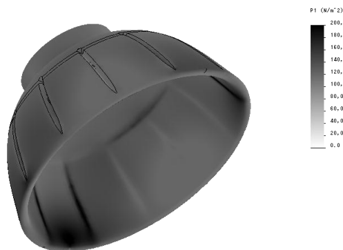
図4 割れ誘導線裏（15° ,45° ,75°）の最大主応力
