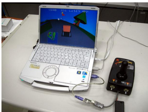
図2 操作レバーの接続
