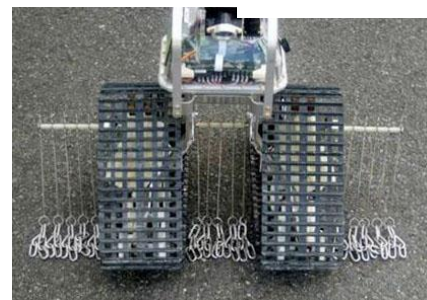
図2 株間除草機構を装着したロボット
