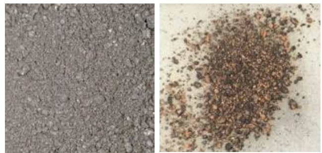
(a)磁選粉末 (b)非磁選粉末 図15:実験後試料粉末写真 NiO+Cu 2 O 800°C
