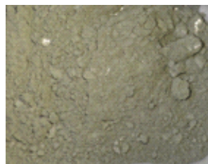
図5：実験後試料粉末 NiO+KH 2 PO 4 700℃
