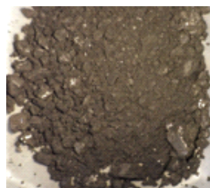
図6：実験後試料粉末 NiO+KH 2 PO 4 800℃
