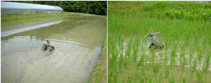
図2 実験の様子（左：初期の作業の様子，右：軟弱土壌で安定した走行が出来ない状態）
