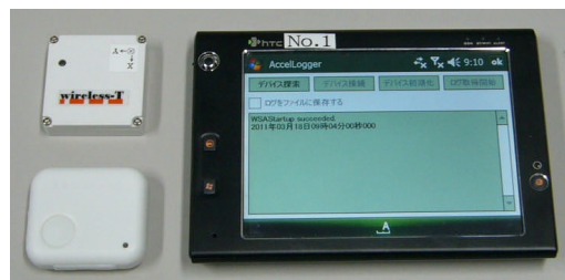
（左上：加速度センサ，左下：加速度／角速度センサ，右：PDA） 図2 システムの外観
