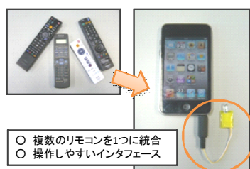
図1 開発リモコンのコンセプトと開発モジュール
