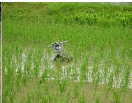
図2 実験の様子（左：初期の作業の様子，右：軟弱土壌で安定した走行が出来ない状態）
