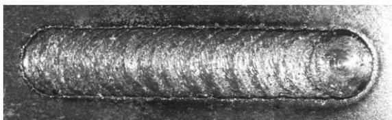
図6 回転数 3000rpm、移動速度 100mm/min でライン FSP を行った試料の外観
