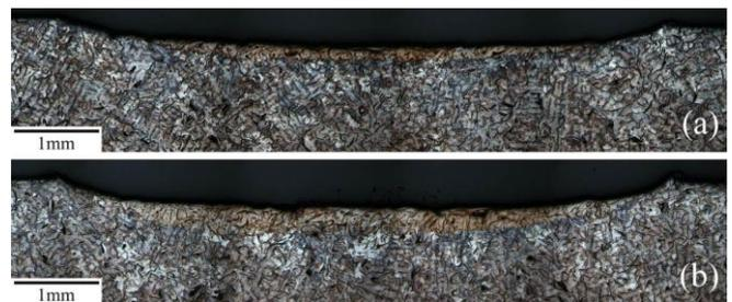
図7 100mm/min で FSP を行った横断面マクロ組織、
