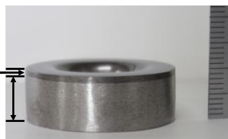
図 3 複合皮膜成型後のダイス全体像
