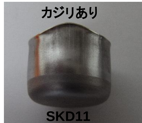
図 4 深絞り成形後の SUS304 (複合皮膜なし)
