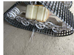
株間除草機構の装着状態（ワンタッチで着脱可能）
