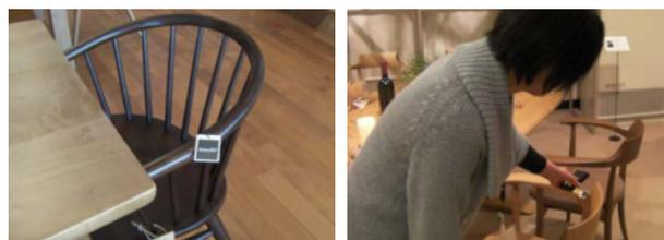
図15 椅子に取り付けた電子タグ
