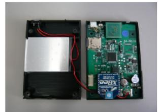
図8 携帯型アンケート端末内部
