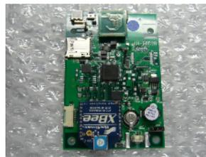
図2 アンケート端末基板
