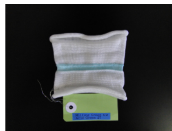
図 3 クレーズを複合化した PP 繊維の染色 水平方向中央部がクレーズを複合化した繊維
