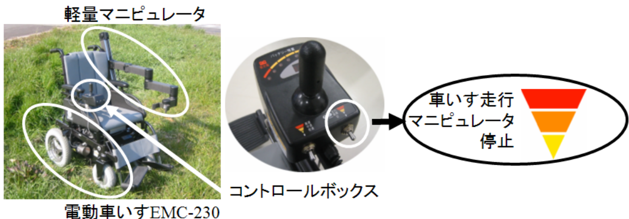
図1 軽量マニピュレータ付き電動車いす
