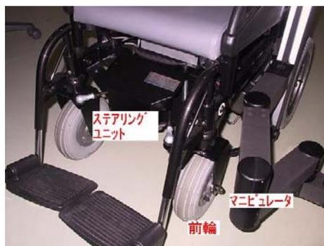
図1 前輪パワーステアリング
