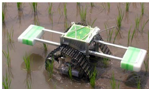
図2 ロボットによる除草作業
