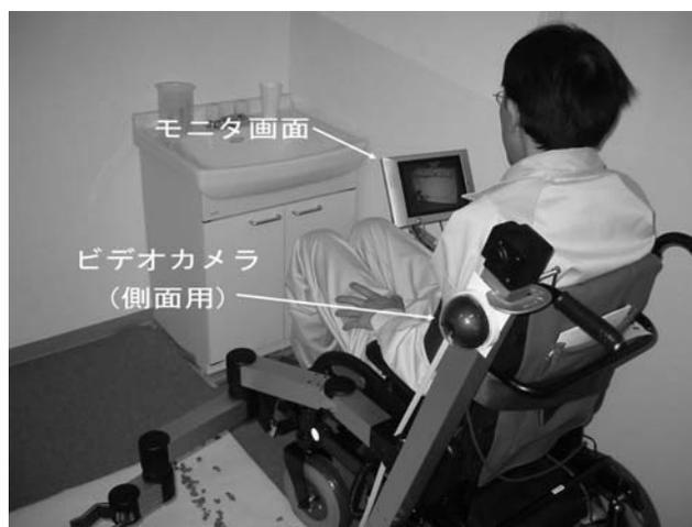
図6 カメラ・モニタシステム
