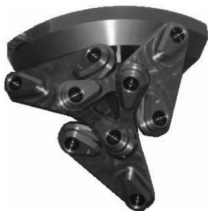
図2 1/8球型全方向ステレオシステム
