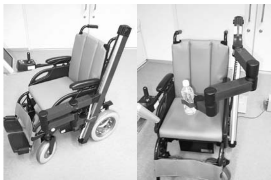
図13 車いすに装着した1号機（左：収納時，右：作業時）
