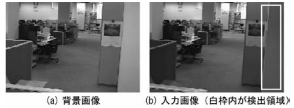
図3 明るさの変化による誤検出例
