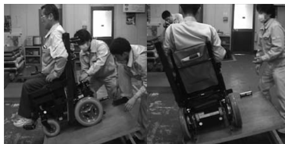
図2 静的安定性試験の様子
