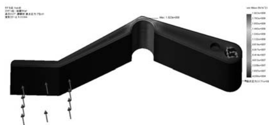
図5 ハンド単体の強度解析の一例（応力分布）
