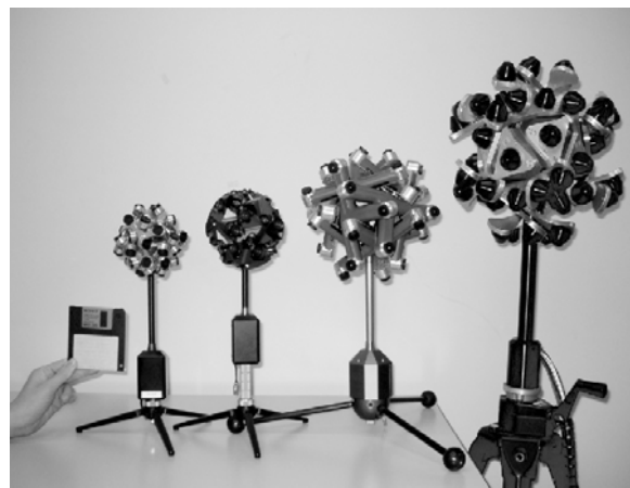
図1 ASTRO-Sensorシリーズの概観 （左から順にVenus，Mercury，Saturn，Jupiter）
