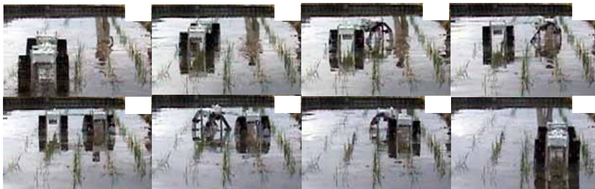
図2 旋回時の様子（前後クローラユニット連結機構あり）
