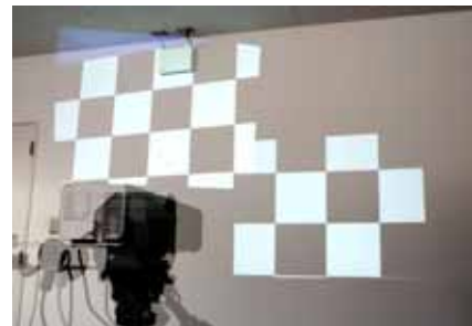
図4 格子パターンの投影（2枚の写真を合成）
