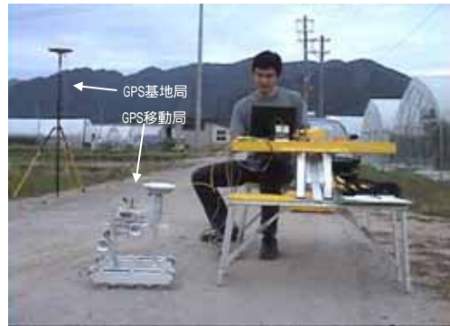
図7 RTK-GPS計測実験の様子
