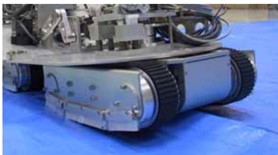
図8 製作したクローラユニット
