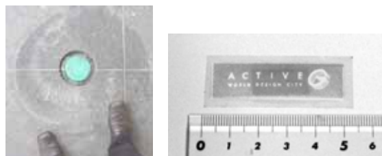
(a) アクティブ型 床面に埋設加工したもの (b) パッシブ型(2.45GHz) 床貼用にパッケージしたもの
