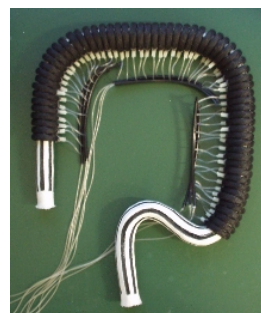
図13 人の大腸を模擬したスリーブに適用したぜん動運動アクチュエータ
