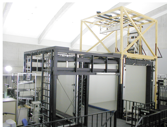
図1 没入型6面ディスプレイシステム（COSMOS）
