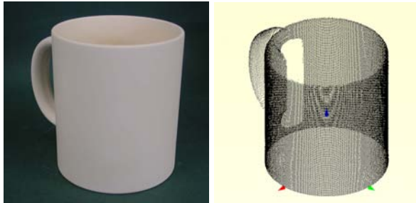
(a)カップの概観 (b)計測結果 図2 ハンドル付カップの計測結果
