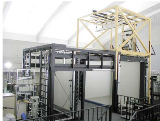
図1 没入型6面ディスプレイシステム(COSMOS)
