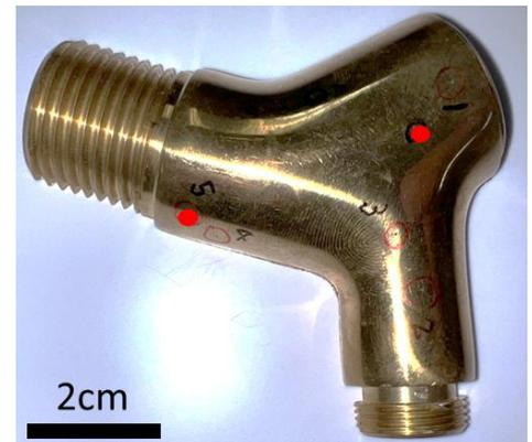
図1 水栓部品の鋳造欠陥の発生箇所（●印）
