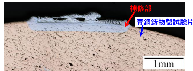
図3 加熱処理後のマクロ断面像
