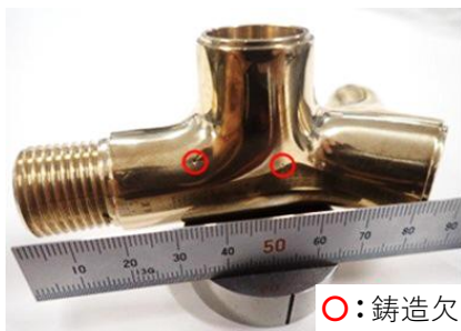
図1 鋳造欠陥を有する青銅铸件製水栓部品
