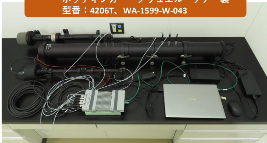
◎対応規格 吸音率：JIS A 1405-2 透過損失：ASTM E2611
