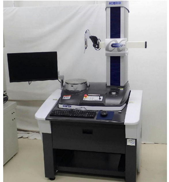
図1 真円度測定機の外観
