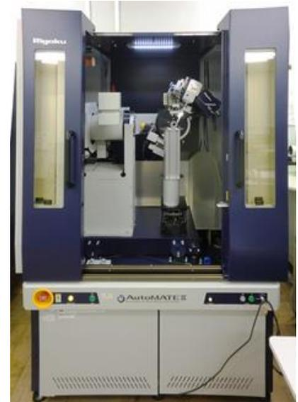
図1 残留応力測定装置
