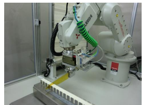
図1 6軸多関節ロボットによる切れ味試験機
