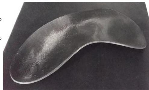
試作したCFRTP製インソール
