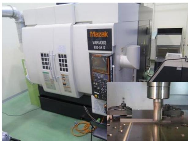
図1 5軸加工機によるCFRP切削加工
